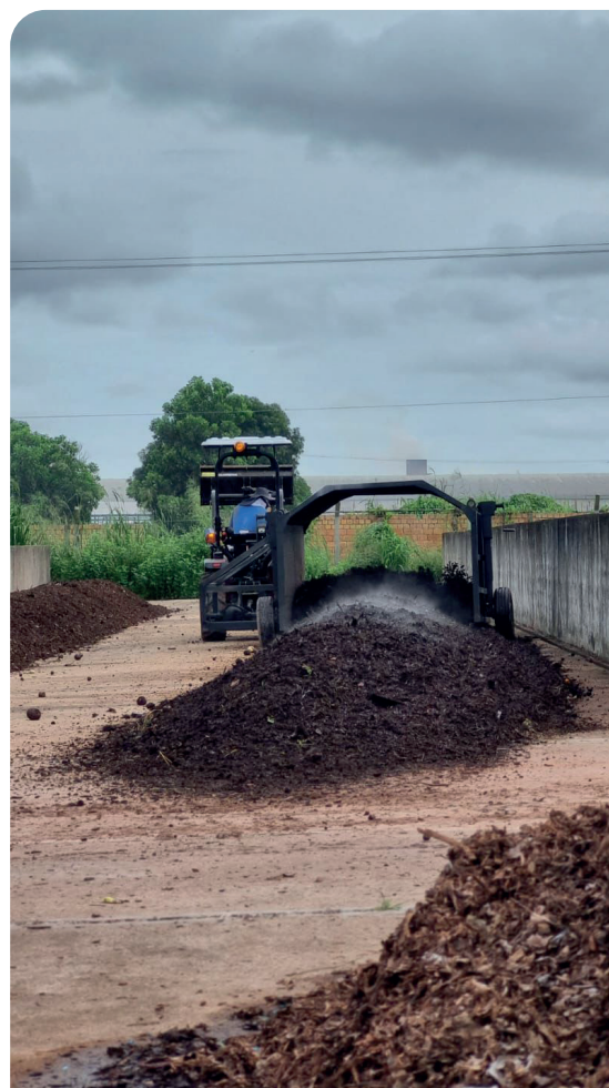
Resíduos orgânicos triturados e misturados com materiais estruturantes para otimizar o processo de compostagem.
